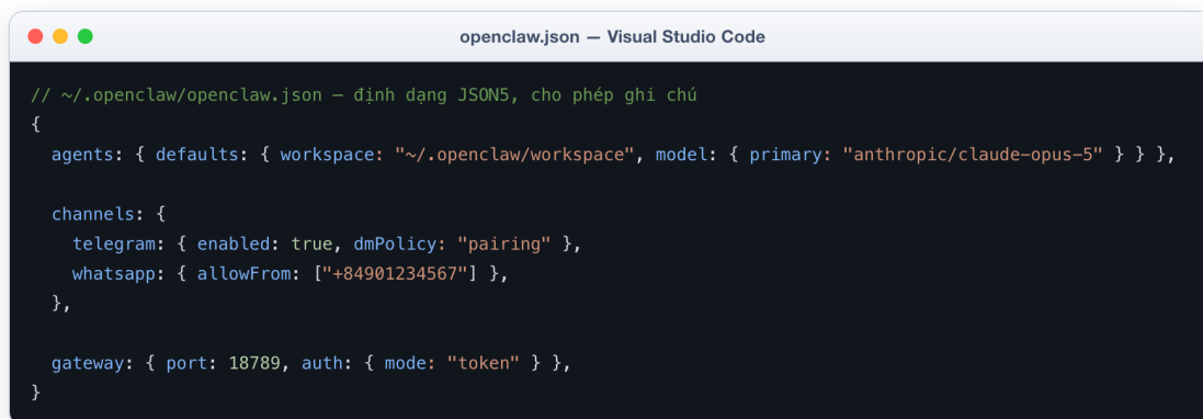
Hình 11. Một tập cấu hình đủ dùng: thư mục làm việc, mô hình chính, hai kênh và cổng gateway
